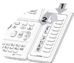
O seu telefone pode estar equipado com um módulo de extensão. O aparelho dispõe, assim, de teclas adicionais que podem ser configuradas como teclas de função, teclas de linha, teclas de chamada ...
